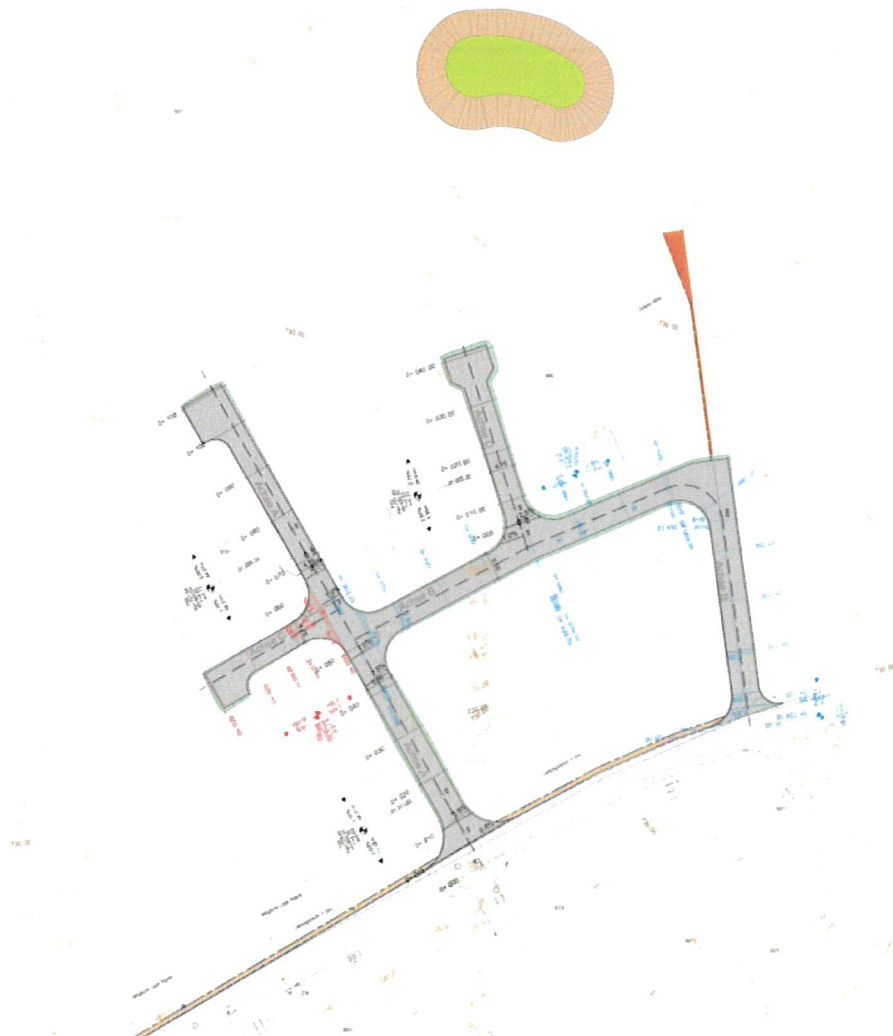
Abbildung 7: Erschließungs- und Entwässerungsplanung Büro Greiner, Stand: 16.11.2020
