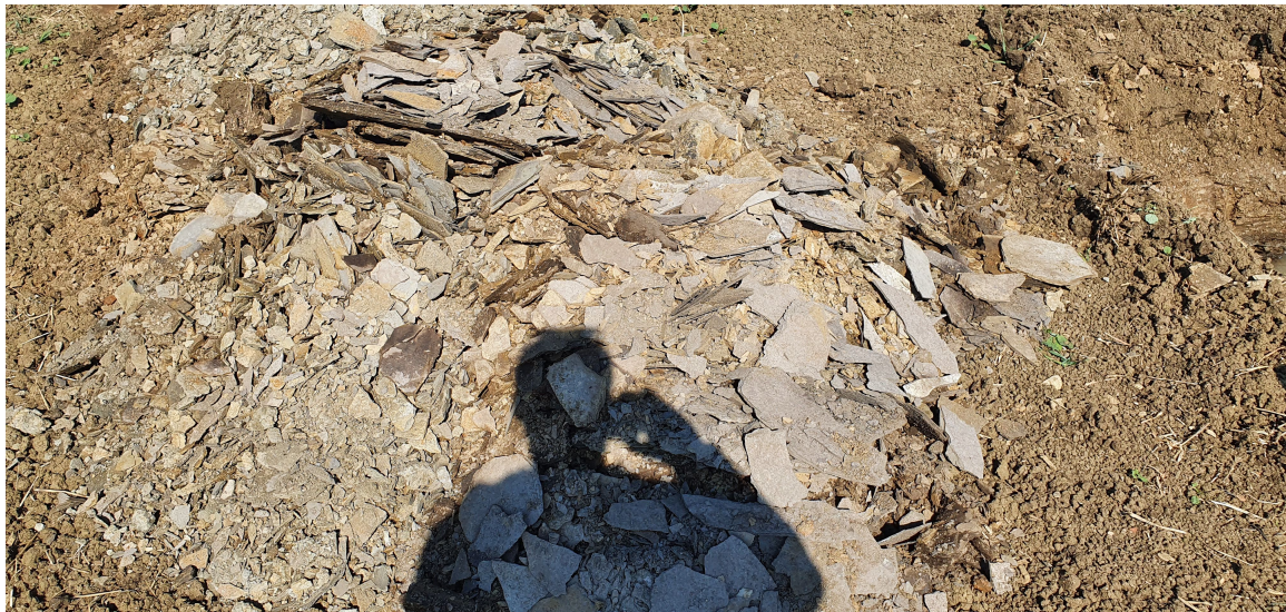
Bild 5: Aushub aus dem Posidonienschiefer in Schurf6
