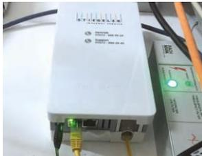
2. Netzabschlussgerät der Fa. Stiegeler, auch kurz NT (Network Terminator) genannt
